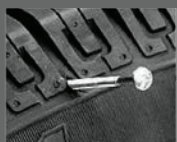
Прокол — обычно единственным очевидным признаком прокола является порез, который проходит от протектора шины через гермослой.
