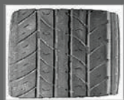
Расслоение плечевой зоны — износ канавки в плечевой зоне шины, обычно является признаком расслоения.
